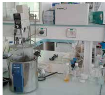
Simulation en laboratoire des programmes de lavage : température, volume d'eau, temps, temps de contact sont respectés
