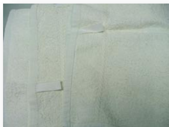
Fig. 6 - Effacement des impressions (marque, composition et entretien) des serviettes éponge après lavages
