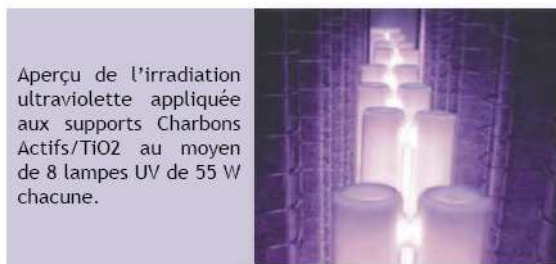
Schéma du pilote mis en oeuvre à l'ENSCR pour les essais d'adsorption et régénération par photocatalyse d'un média Charbons Actifs/TiO 2 .
