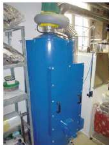
Exemple de récipient rempli de charbons actifs, tel que décrit dans l'approche ci-dessus.
