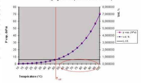
凶 au-delà de 50°C environ, la pression de vapeur augmente nettement sur ce graphe, de même que la concentration en vapeurs de solvant, intimement liée; ଧ la LIE est représentée par une ligne horizontale noire : elle se situe à 0,63 %; ଧ dans le cas du solvant correspondant à ce graphe, à saturation, la LIE est atteinte dès 51°C (représentée par la verticale rouge TLIE).
