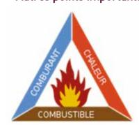
L'inflammation d'un combustible (mélange vapeurs de solvant/air, en l'occurrence) est rendu possible par la présence de deux autres éléments :
