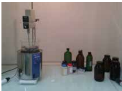
Essais réalisés en laboratoire (préparation de l'échantillon), visant la mise en évidence des interactions éventuelles entre les produits, en excluant tout autre paramètre : textiles, matériel de lavage, salissures. Les températures, durées et concentrations pratiquées en blanchisseries ont été respectées lors des essais simulés en laboratoire, à partir de produits lessiviels seuls.
