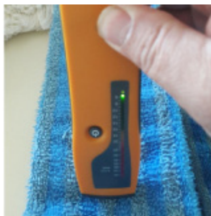
Deux bandeaux différents (même composition mais fabrication différente) dans la même charge ayant subi le même traitement. Les indications données par l'humidimètre sont bien différentes.
