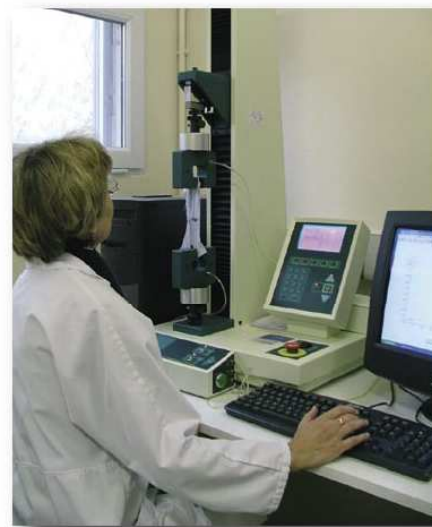
Fig.8 - Force maximale de rupture des coutures normalisées par la méthode d'arrachement (Grab test)
