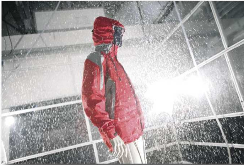
Fig.2 Mesure d'imperméabilité d'une veste Quechua (source : Décathlon)
