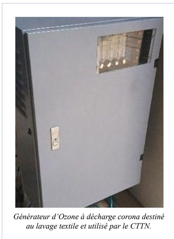
Cette étude a été réalisée à partir de deux méthodes d'injection d'ozone dans les processus de lavage industriel. La première méthode impliquait l'usage d'un injecteur fritté, conçu pour une diffusion homogène et fine de l'ozone dans le bain de lavage, pendant toute la durée du cycle, tandis que la seconde reposait sur un dispositif Venturi, exploitant un effet de vide pour incorporer l'ozone dans l'eau lors des phases de remplissage.
