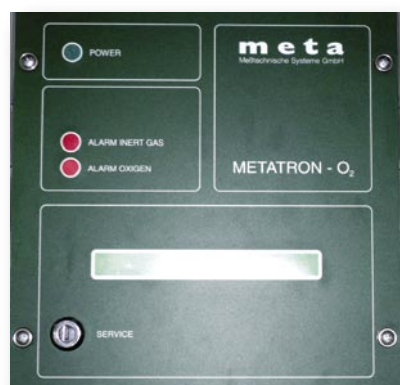
Systeme de controle de l'inertage de la machine
