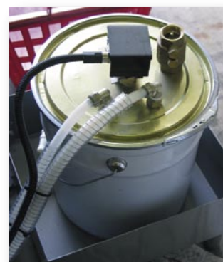
Vidange automatique des résidus de distillation
