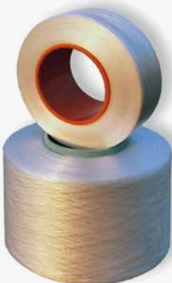
Le polyuréthane est le résultat de réactions mettant en jeu un polyglycol (butane diol par exemple) et un polyisocyanate (diisocyanate de toluène par exemple). Le polyuréthane chaud et visqueux obtenue est extrudé à travers une filière. De ce dispositif à nombreux orifices minuscules sortent, au refroidissement, des filaments d'élasthanne élastomère (polymère élastique).
