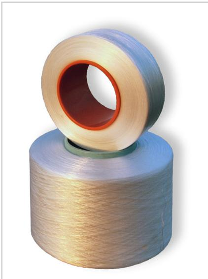
Lorsque l'on parle d'élasticité d'un article textile, il s'agit de la propriété d'un textile lui permettant de s'allonger s'il est soumis à une certaine forme de tension, et de reprendre totalement ou partiellement son état initial, lorsque cette tension disparaît.
